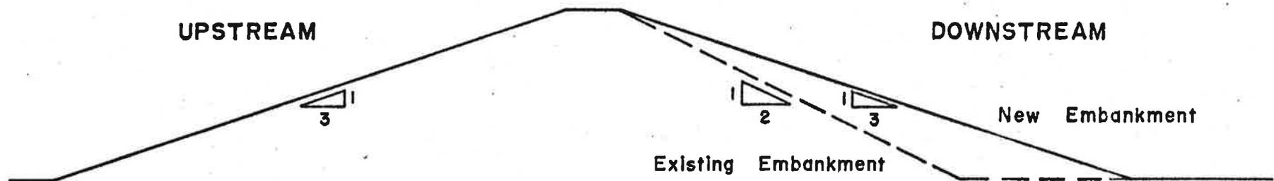
TYPICAL CROSS-SECTION BETWEEN STA. 0+00 AND STA. 5+00
